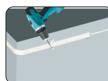
④ 按上卡扣，打上自攻螺丝，固定紧灯带
